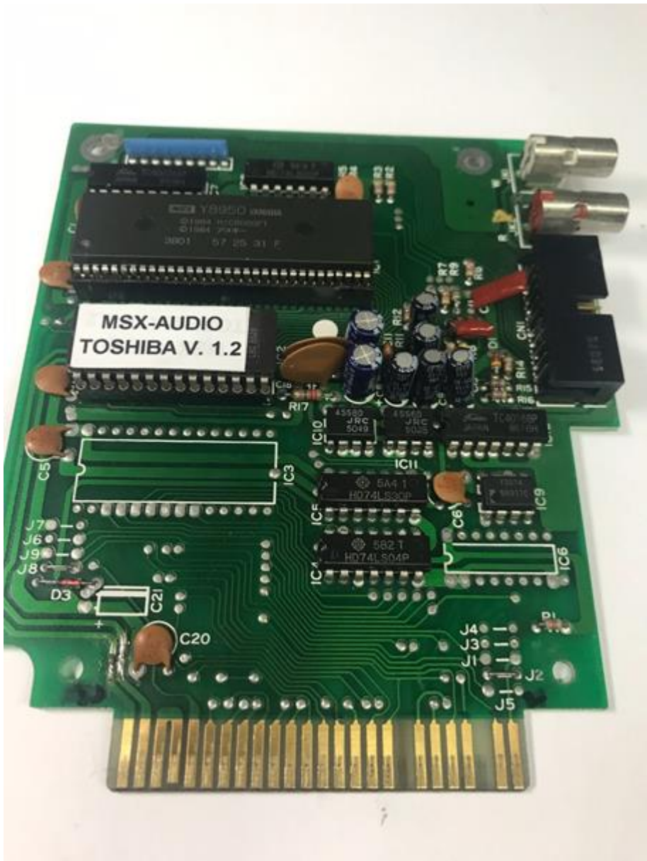
Standard Toshiba HX-MU900 PCB.
